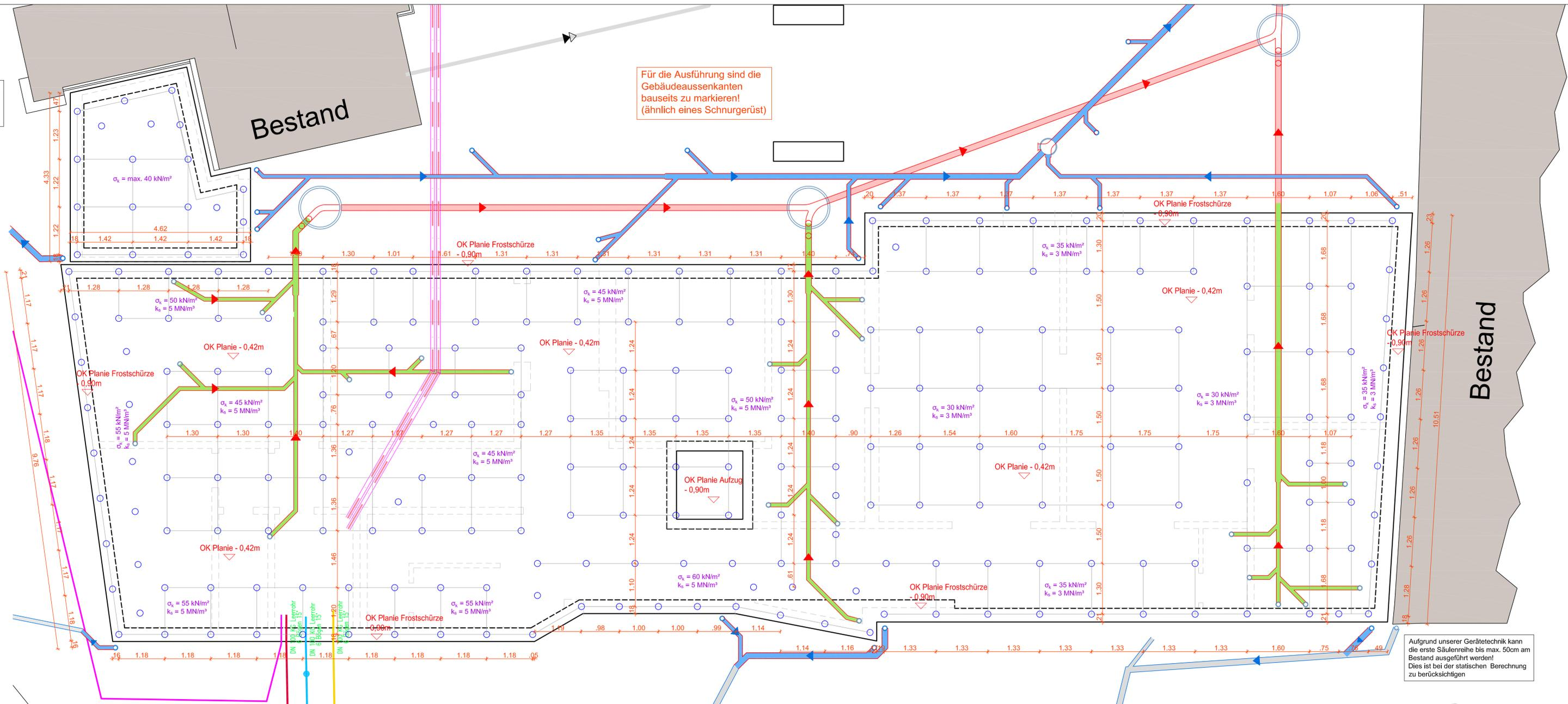
Aufgrund unserer Gerätetechnik kann die erste Säulenreihe bis max. 50cm am Bestand ausgeführt werden! Dies ist bei der statischen Berechnung zu berücksichtigen
